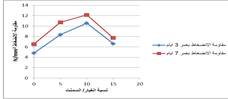
شكل (3) : تأثير غبار افران الاسمنت على مقاومة الانضغاط للمونة
