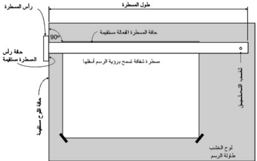
شكل 4.2: مسطرة (الحرف) T تنزلق أفقياً على لوح خشبي مثبت عليه ورقة رسم
