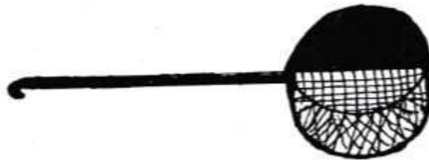
شكل (26) : مغرفة مؤلفة من نصفين الاول سلكي ، والآخر معدني تستخدم لجمع حشرات الماء . مقياس الرسم = \frac{1}{15} .
