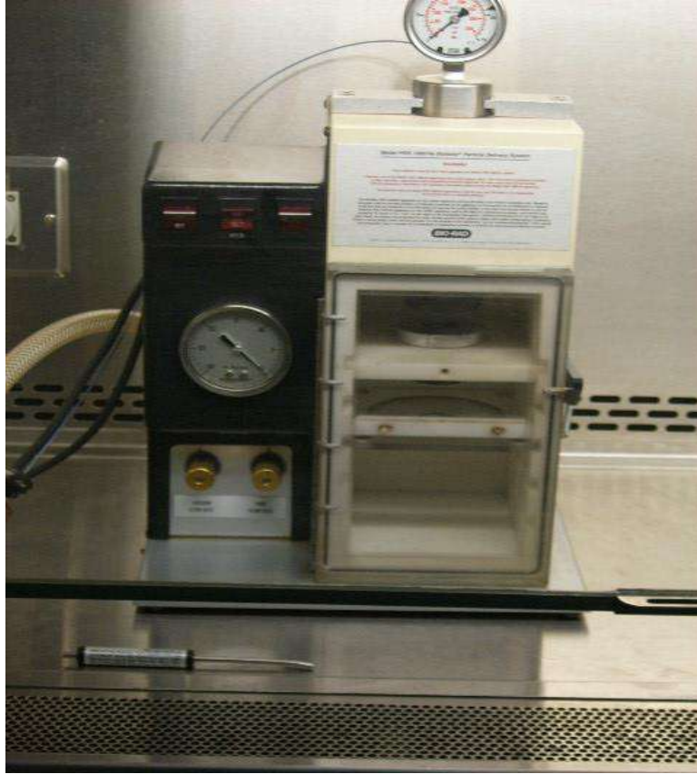
شكل (٦٤) جهاز قذف الجين العامل بغاز الهليوم المستخدم في مختبرات التقانة الحيوية
