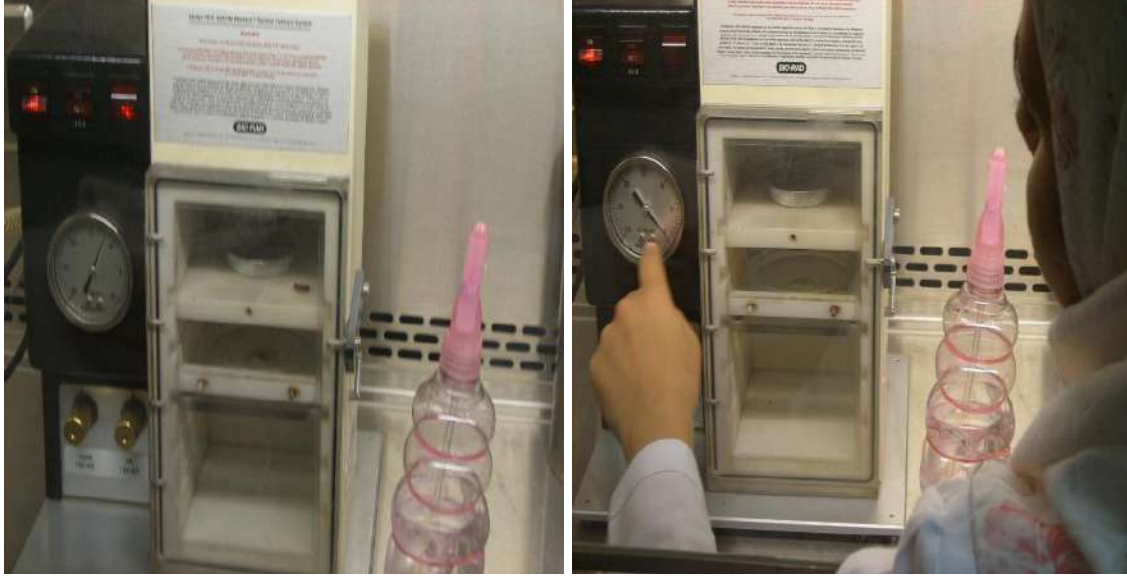
شكل ( ٦٥ ) خطوات استخدام جهاز قذف الجينات العامل بغاز الهليوم
