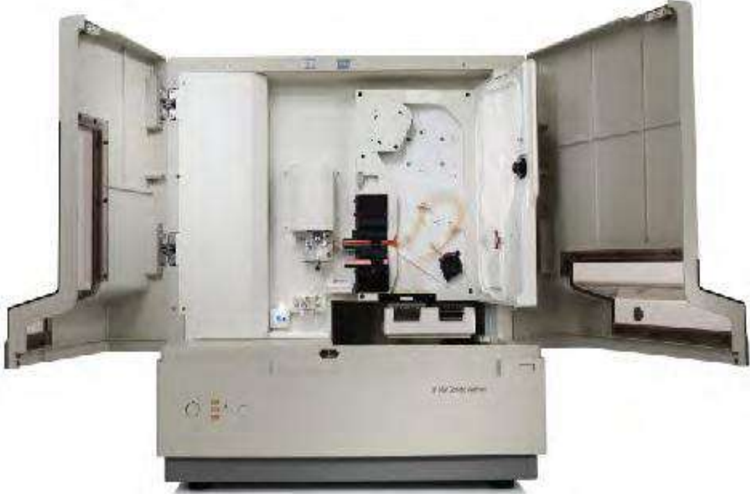
شكل ( ٣٦ ) جهاز تحليل الوراثة (شركة ٣١٣٠ Applied biosystemes model ) (عن رفعت ، ٢٠١٤ )
