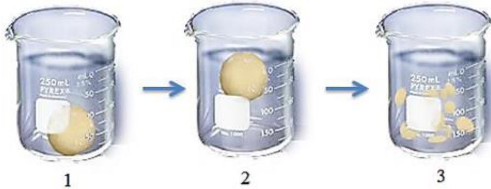
شكل (1) مراحل تفكك العجينة في اختبار بلشكي
