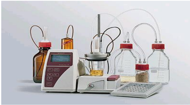
الشكل (11): جهاز كارل فيشر الحديث لتقدير الرطوبة
