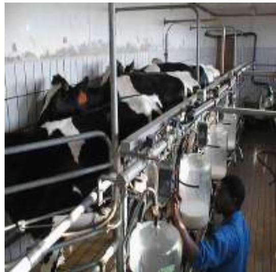
شكل ( 9 - 21 ) محلب ميكانيكي تقف فيه الأبقار على شكل زاوية
