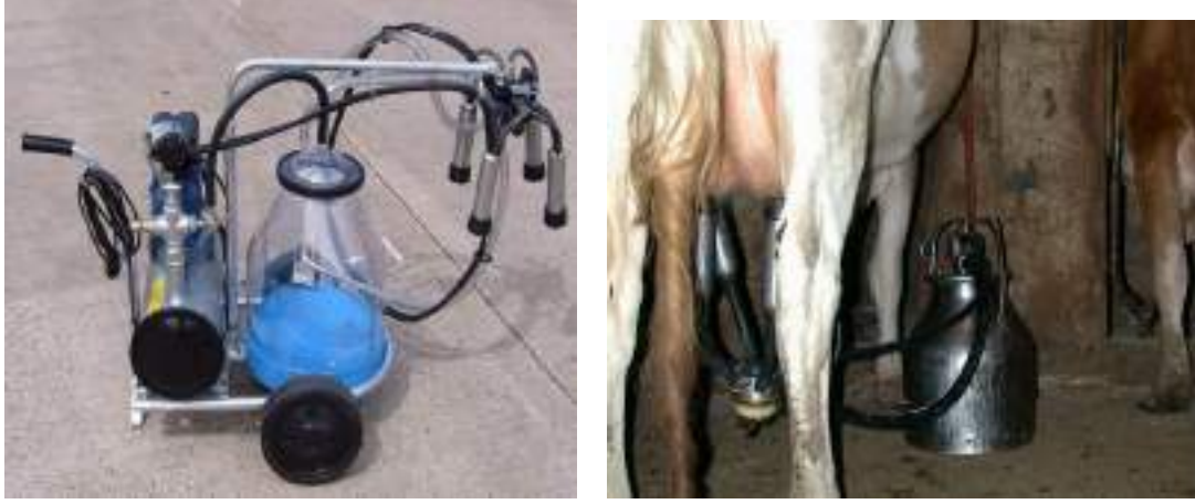
شكل ( 9 - 14 ) الحلب بإناء الحليب والحلب بماكنة حليب متنقلة
