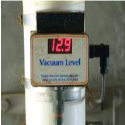
شكل ( 9 - 8 ) مضخة التفريغ مع مقياس مستوى تخلخل الضغط
