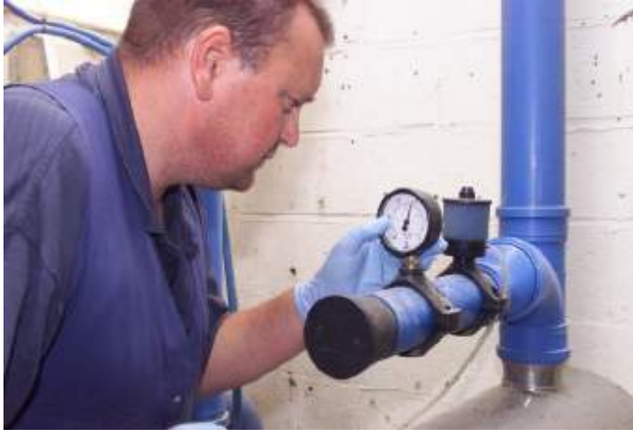
شكل ( 9 - 13 ) فحص مقياس تخلخل الضغط قبل البدء بعملية الحلب
