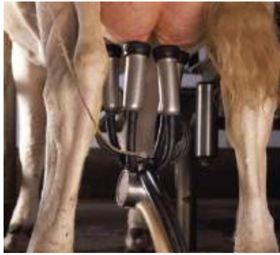
شكل ( 9 - 10 ) وحدة الحلب (كؤوس الحلمات أو الأقماع) قبل بدء الحلب
