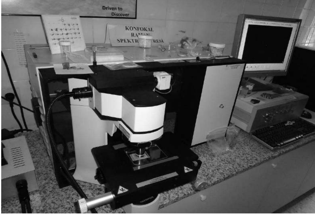
(الشكل أعلاه لجهاز الرامان لفحص حبيبات الرمل تحت المجهر)
