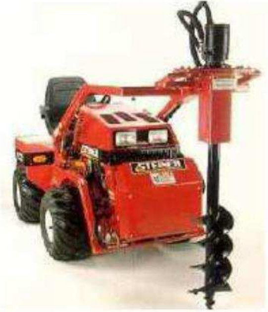
آلة حفر الجور توجه وتدفع بالجهاز الهيدروليكي وتدار بمحرك خاص بها
