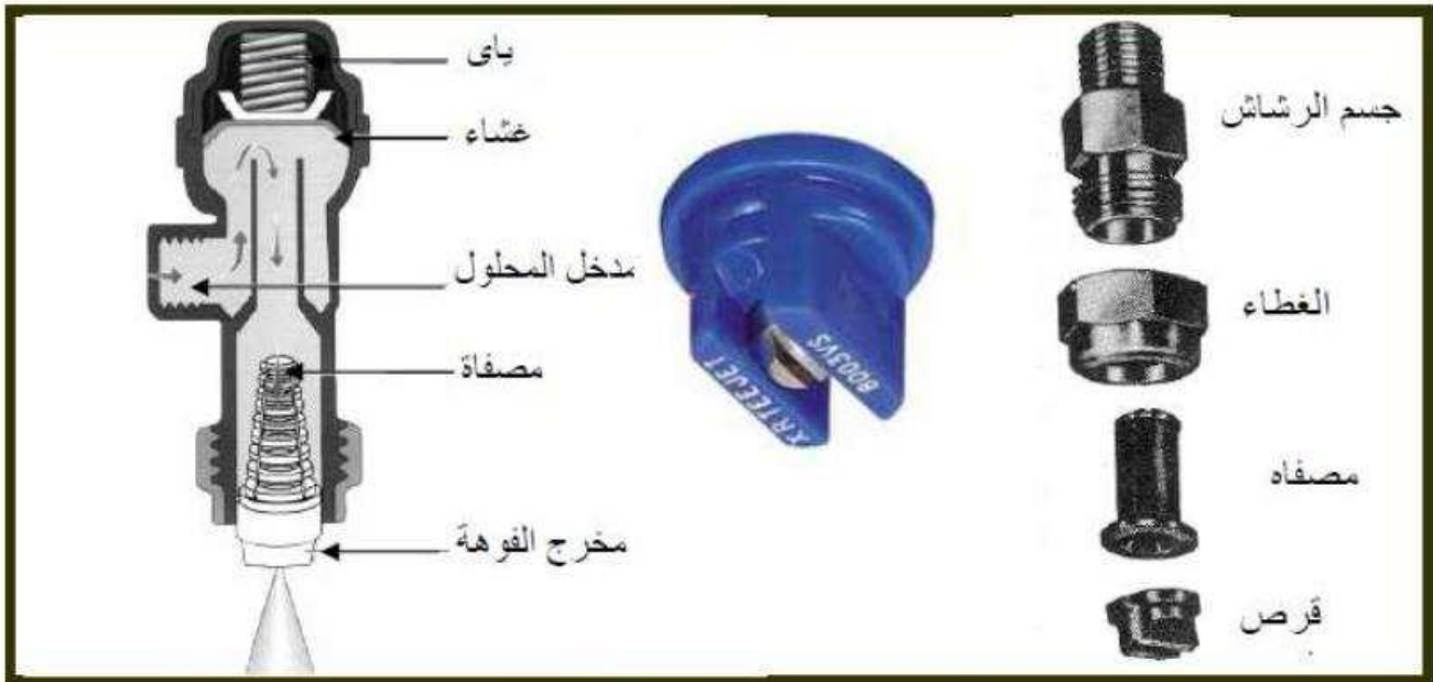
شكل (٦٢): أجزاء النافورة الرش
