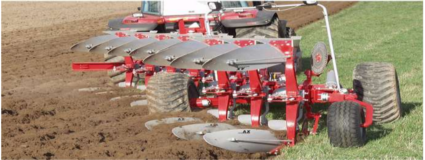
طريقة العمل بالمحراث المطرحي القلاب ذو الاتجاهين
