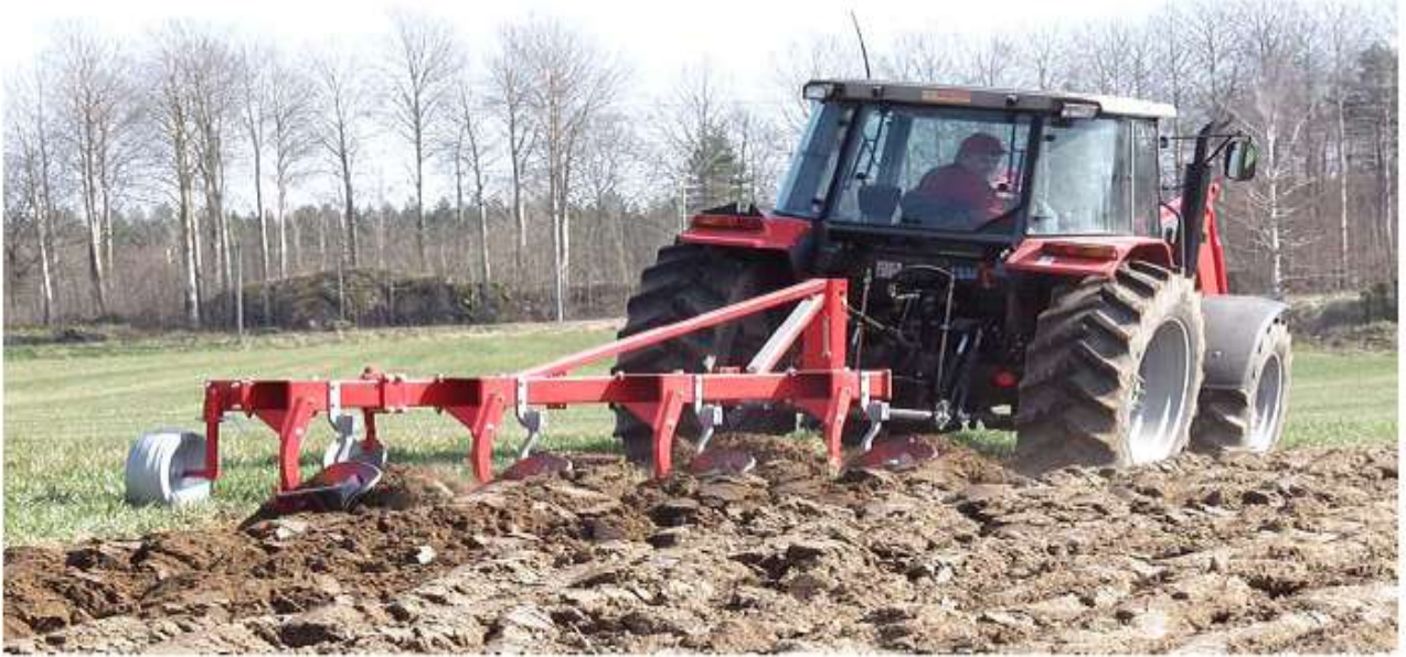
شكل رقم ٢/١١. طريقة العمل بالمحراث المطرحي القلاب
