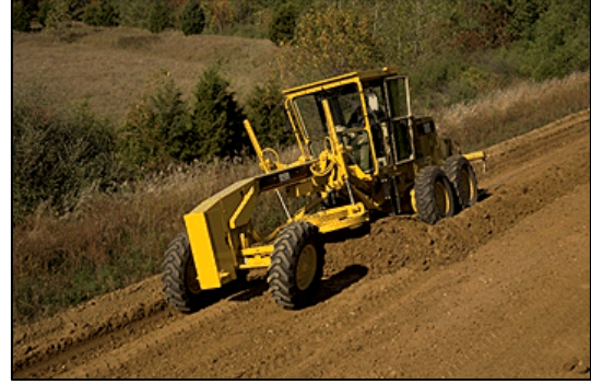
شكل رقم ( ٢ - ٧ ) اللقطات توضح القريدر أثناء العمل
