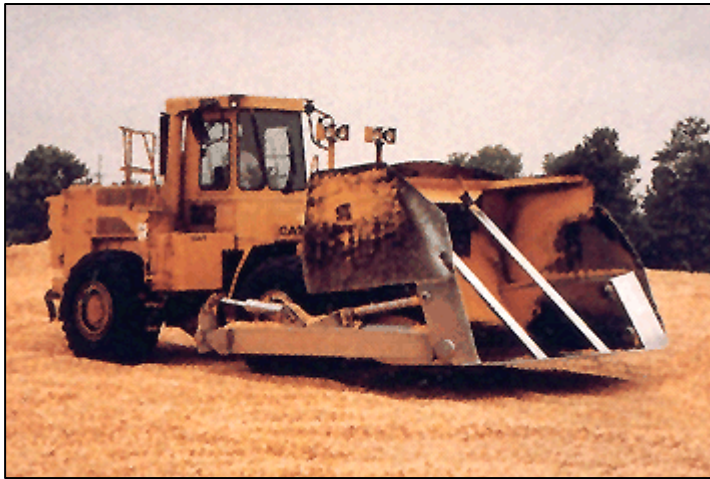
شكل رقم ( ٢ - ٤ ) البلدوزر ذو العجلات
