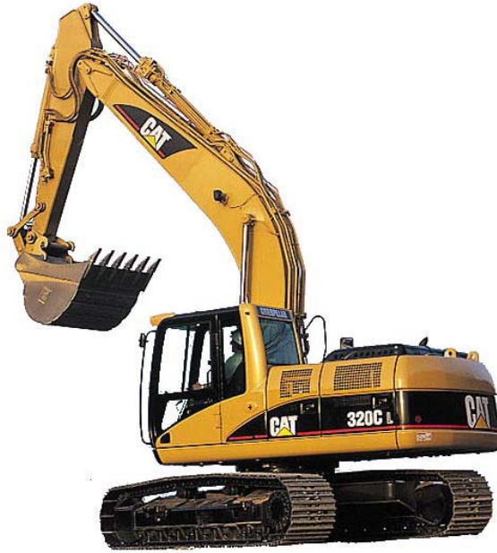
شكل رقم ( ٢ - ٨ ) حفار هيدروليكي على جنزير
