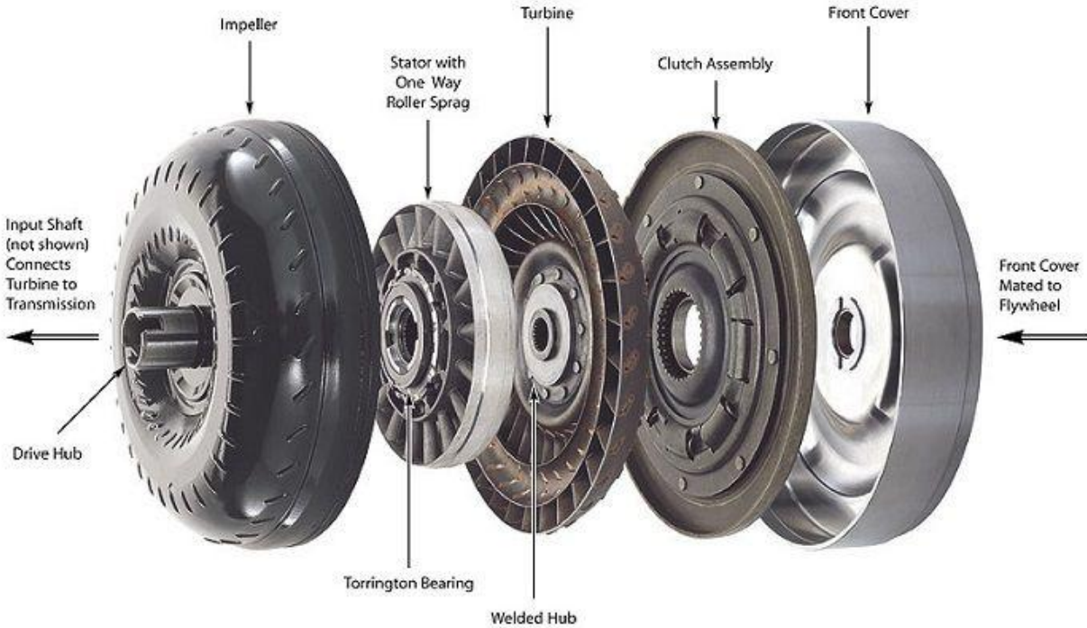
شكل (2) صورة لأجزاء الفاصل الهيدروليكي
