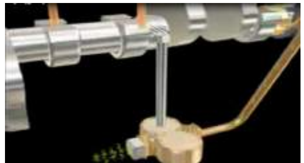
شكل يبين وسيلة نقل الحركة الى مضخة الزيت
