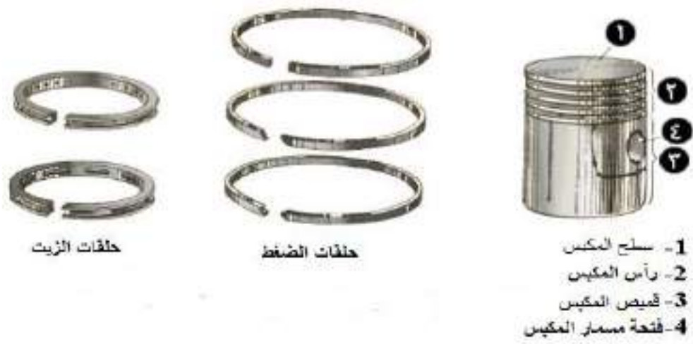
شكل يبين أجزاء المكبس وأنواع حلقات المكبس
