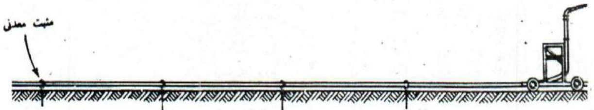
٤ - ٢٦ الأوتاد المعدنية المستخدمة لتثبيت السلك أو الخرطوم في حالة انحدار عرضي شديد
