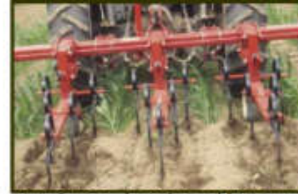
شكل (٤٦): عزاق ذات أسلحة زئبركية حطارة معلقة خلف الجرار
