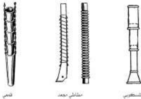
الشكل رقم ٣/٨. بعض أنواع أنابيب الزراعة المستخدمة مع آلات الزراعة
