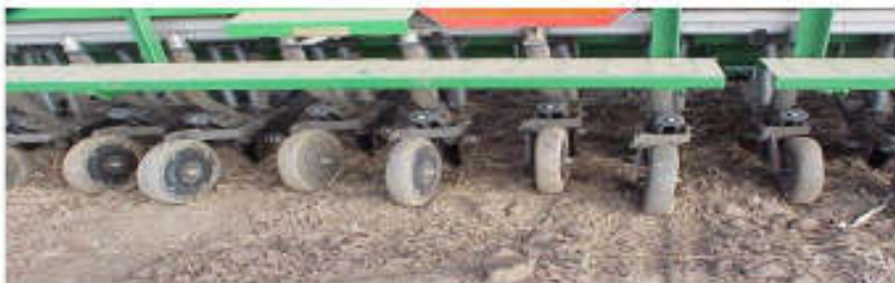
الشكل رقم ٣/١٠. استخدام المحلات البلاستيكية في تغطية البذور.
