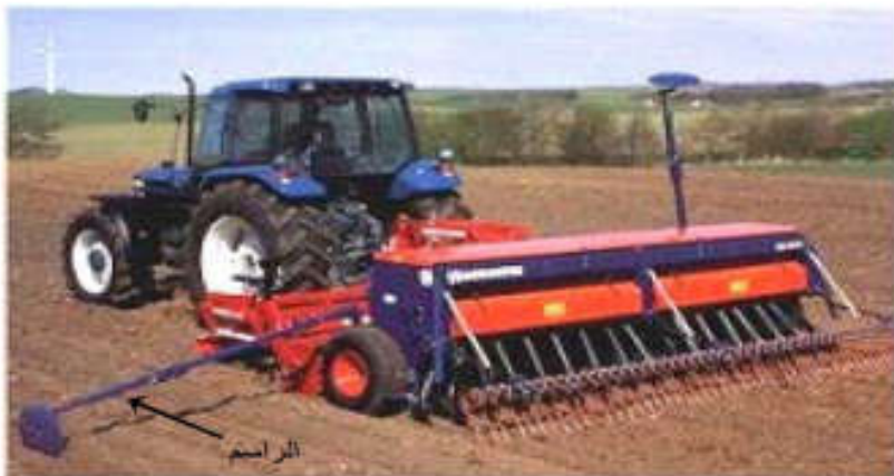
الشكل رقم ٣/١٢. طريقة استخدام الراسم في آلة تسطير البذور
