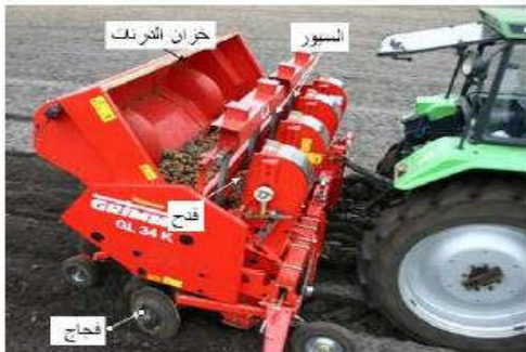
شكل (١٠٤) آلة زراعة البطاطس الرأسية ( ذات السيور و الأقداح )
