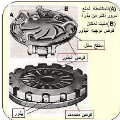
شكل ( ٩٧ ) مكونات جهاز التلقيح ذو القرص الأفقي في آلات الزراعة على خطوط
