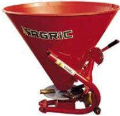
الشكل رقم ٣/٢. آلة نشر البذور بالقوة الماردا المركزية
