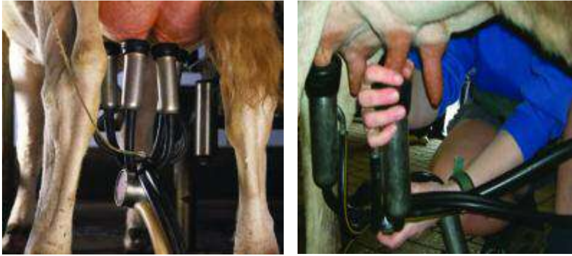
شكل ( 9 - 10 ) وحدة الحلب (كؤوس الحلمات أو الأقماع) قبل بدء الحلب
