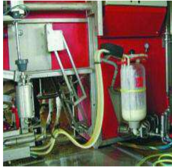
شكل ( 9 - 26 ) التركيب الميكانيكي ووحدة الأشعة الليزرية حيث تقوم بتثبيت كؤوس الحلمات
