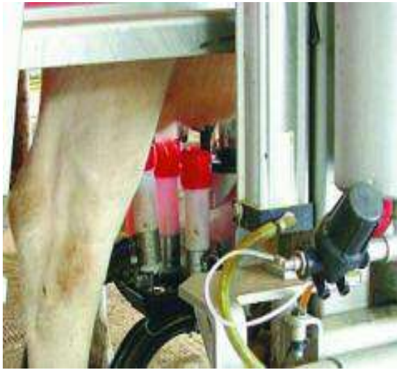
شكل ( 9 - 26 ) التركيب الميكانيكي ووحدة الأشعة الليزرية حيث تقوم بتثبيت كؤوس الحلمات
