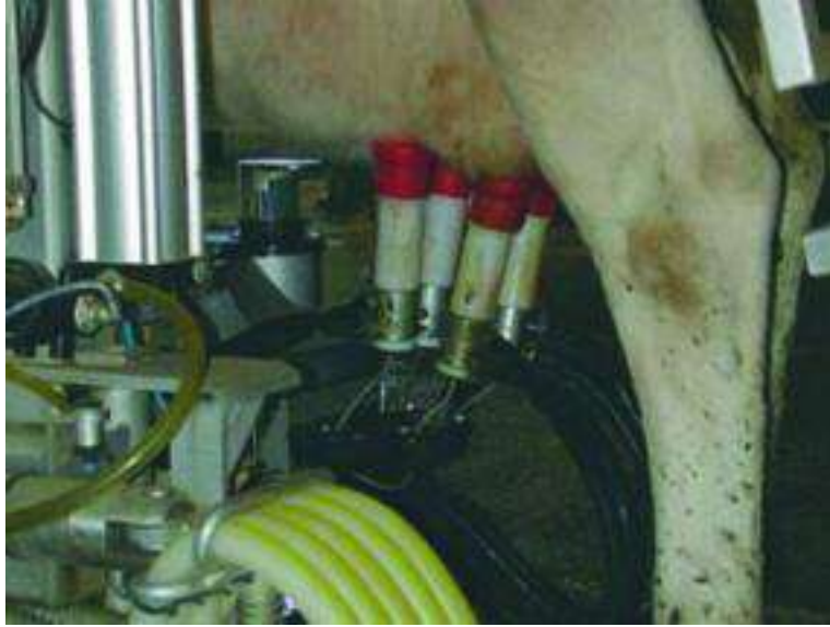
شكل ( 9 - 27) تثبيت كؤوس الحلمات وبدأ عملية الحلب
