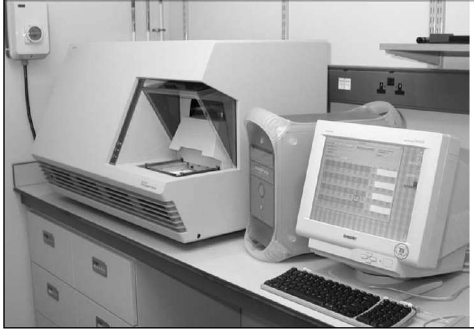
الشكل (29-9): جهاز PCR نوع ABI 7700 quantitative PCR machine
