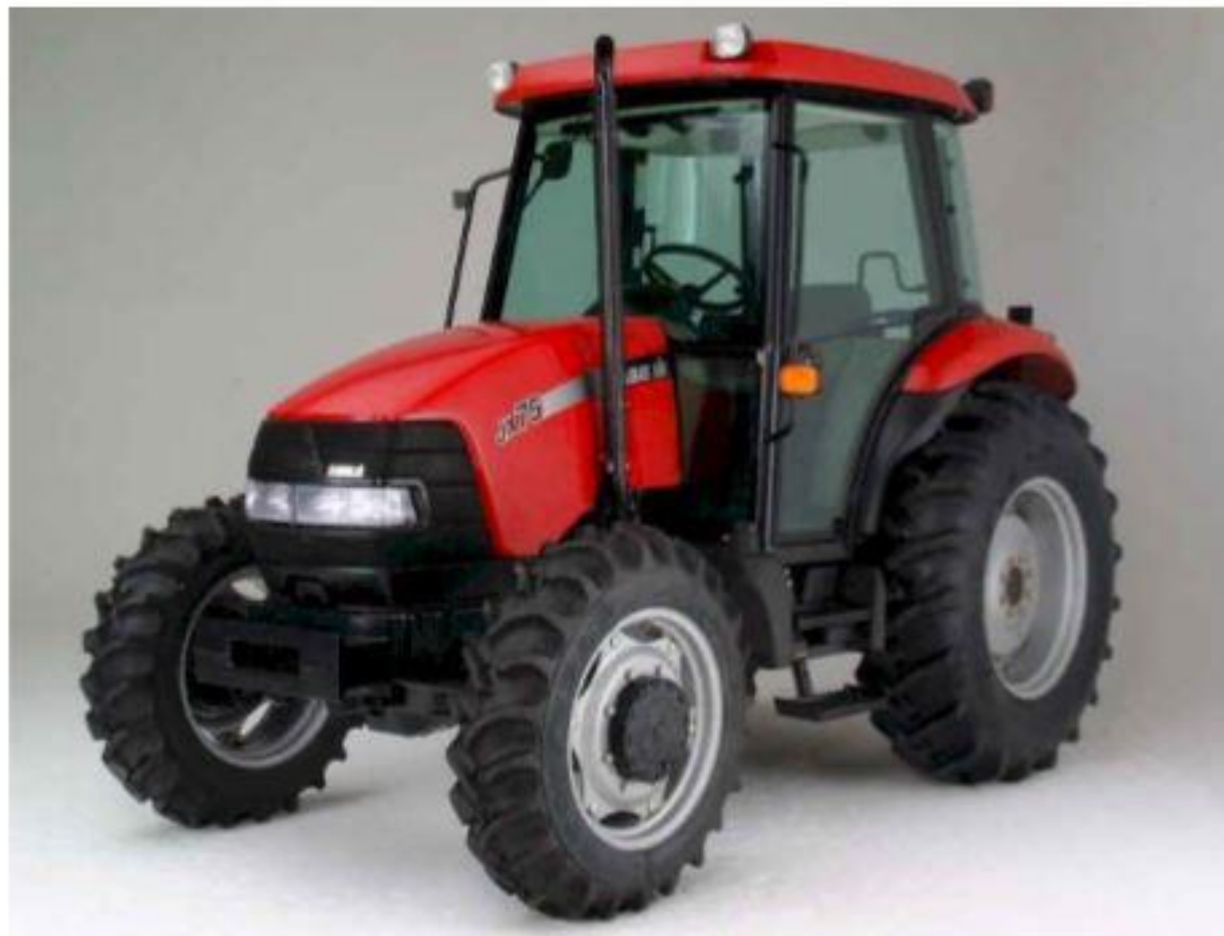
الشكل رقم ١/٩ جرار ذو دفع رباعي ( العجلات الأمامية والخلفية يوجد عليها بروزات )
