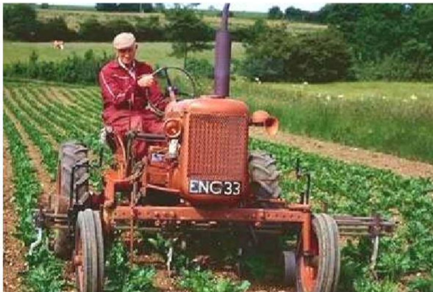
الشكل رقم ١/٤. جرار محاصيل الصفوف بأربع عجلات
