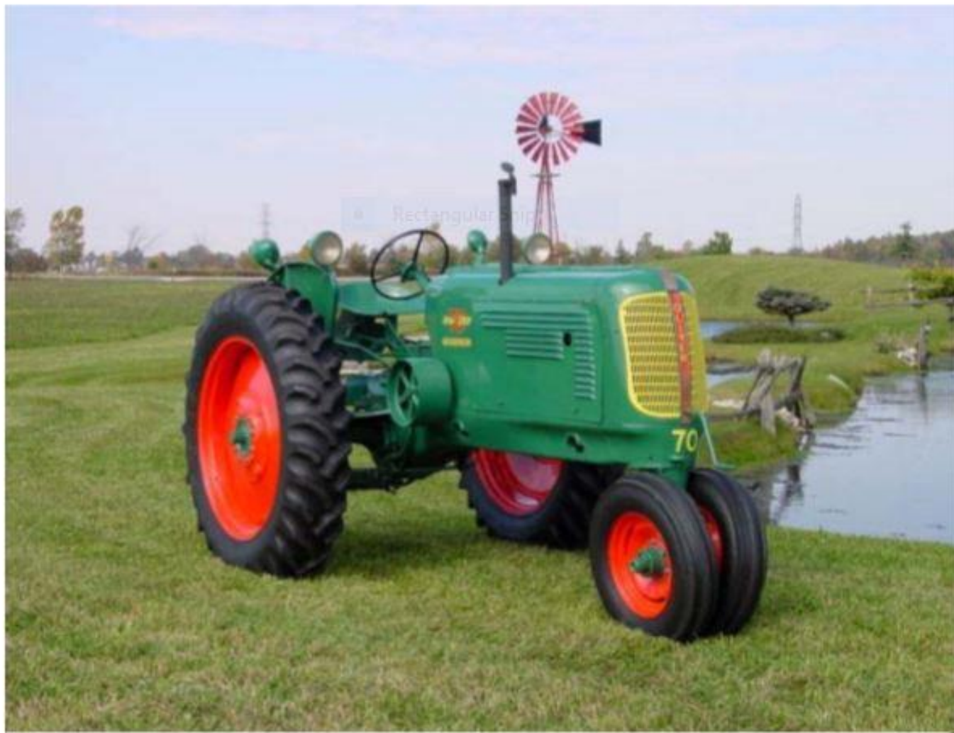
الشكل رقم ١/٣. جرار محاصيل الصفوف بثلاث عجلات
