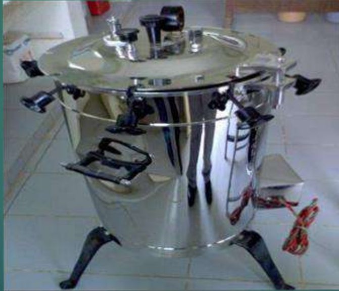
صورة رقم (٦) جهاز الاتوكليف (التعقيم بالبخر تحت الضغط)
