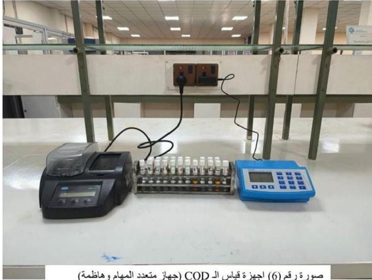
صورة رقم (6) اجهزة قياس الـ COD (جهاز متعدد المهام وهاظمة)
