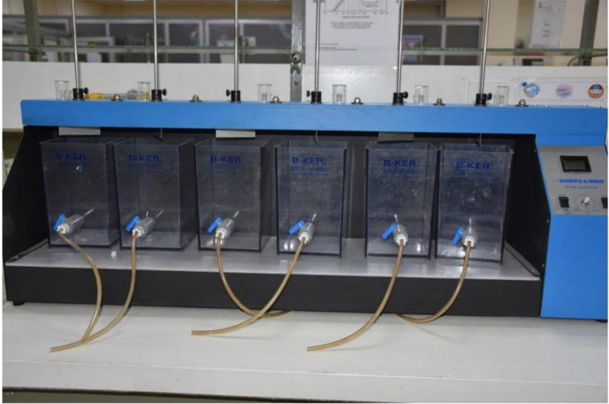
صورة رقم (3) جهاز فحص الجرة
