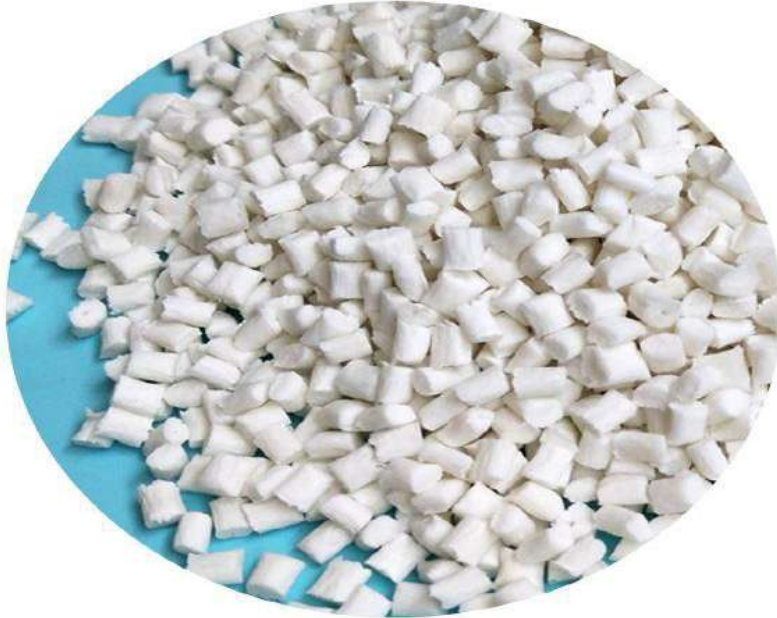
الشكل (8) : الاسطوانات البلاستيكية المنتجة
