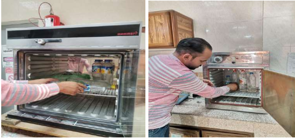
الشكل (2) : الفرن نوع (Memmert) المستخدم للتجفيف
