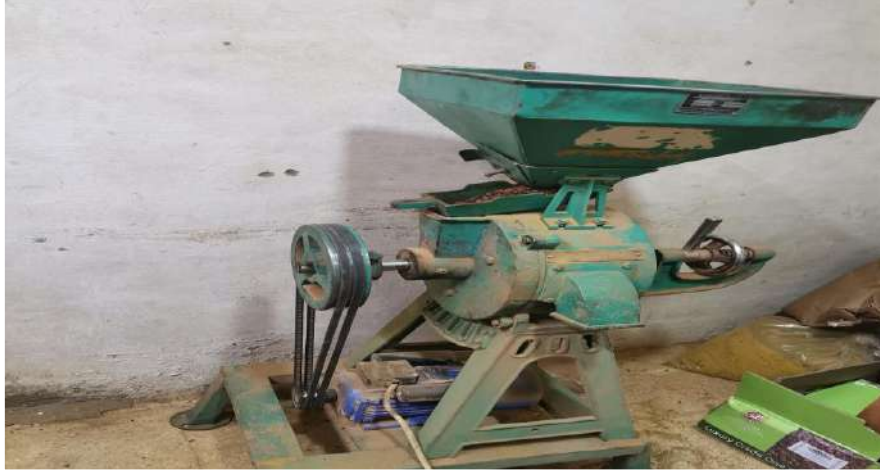
الشكل (3) : آلة تقطيع المواد البلاستيكية
