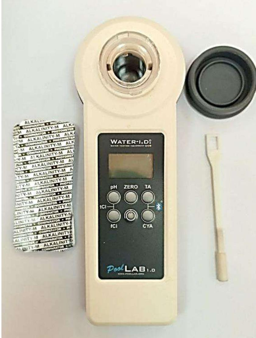
شكل (1) صورة الجهاز المستخدم في فحص جودة المياه في مسابح الموصل
