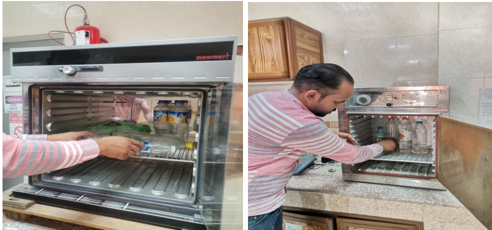
الشكل (2) : الفرن نوع (Memmert) المستخدم للتجفيف
