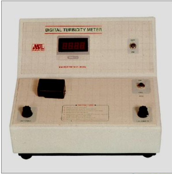
لقياس كدرة المياه Nephelometer جهاز النيفلوميتر
