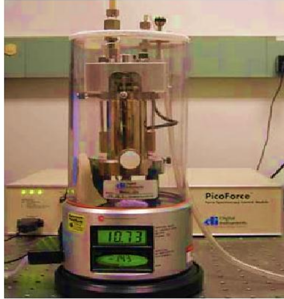
شكل رقم (٢٧-٢) مجهر القوة الذرية (AFM) (٣٢).
