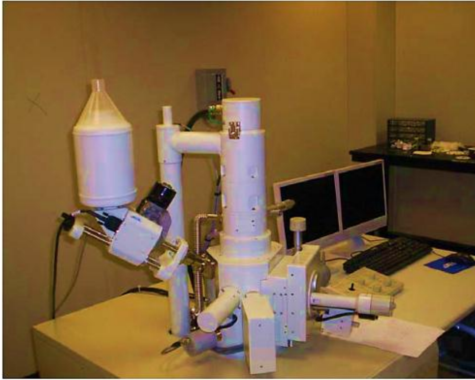
شكل رقم (٢-٢١) صورة للمجهر الإلكتروني الماسح (SEM) (٢٤).
