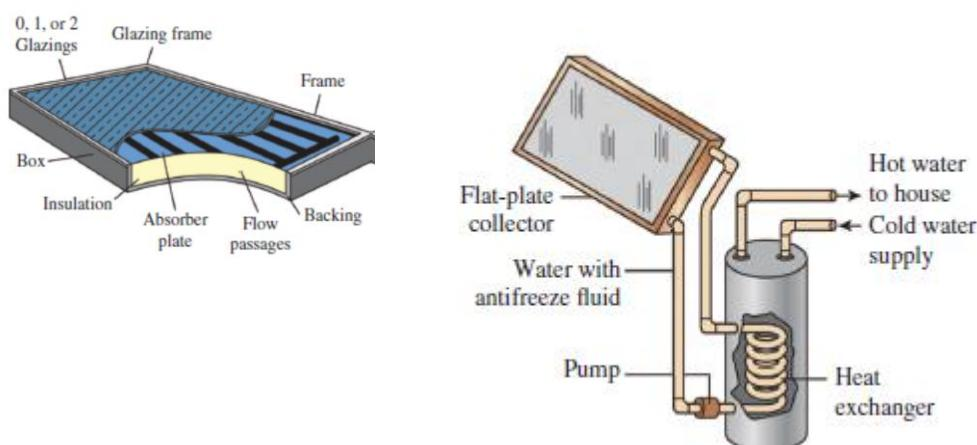
تقوم لوحة الامتصاص بامتصاص الطاقة الشمسية المنقولة عبر الزجاج، وهو نوع من الزجاج. يتم توصيل أنابيب التدفق بلوحة الامتصاص ويتم تسخين الماء أثناء تدفقه في الأنابيب عن طريق امتصاص الحرارة من لوحة الامتصاص. الجوانب والظهر معزولون لتقليل فقدان الحرارة.
