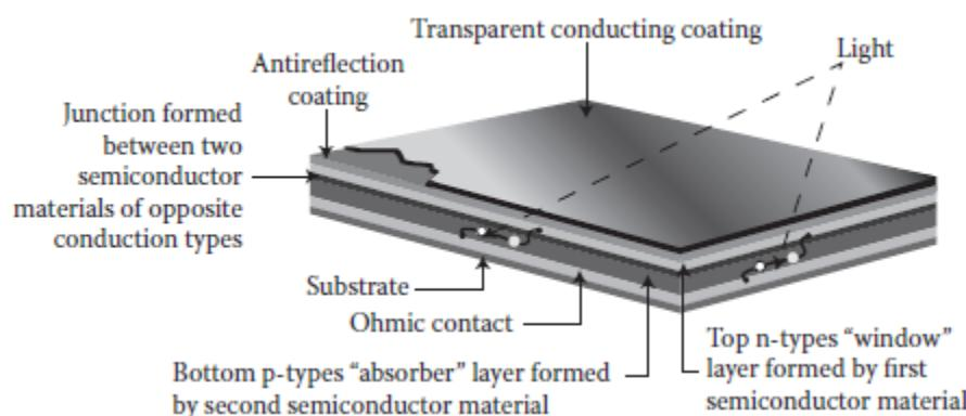
الخلايا الكهروضوئية تولد الكهرباء مباشرة من تفاعل الطاقة الإشعاعية مع أشباه الموصلات الموجودة في الخلايا الكهروضوئية.
