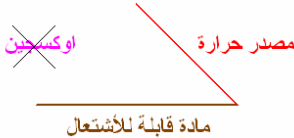
شكل (٢-٢) : مثلث الاطفاء ( الخنق... منع اوكسجين الهواء ) .
