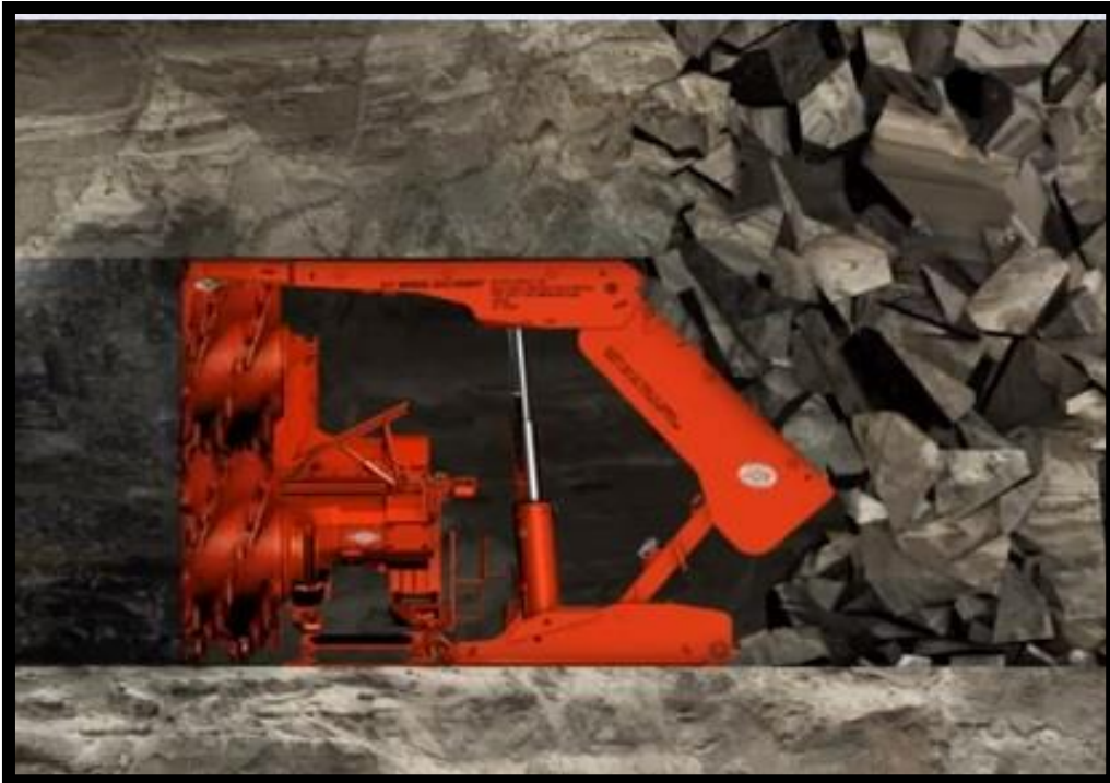
شكل رقم (46-6) معدات متخصصة لقلع الخام من اماكن تواجد
