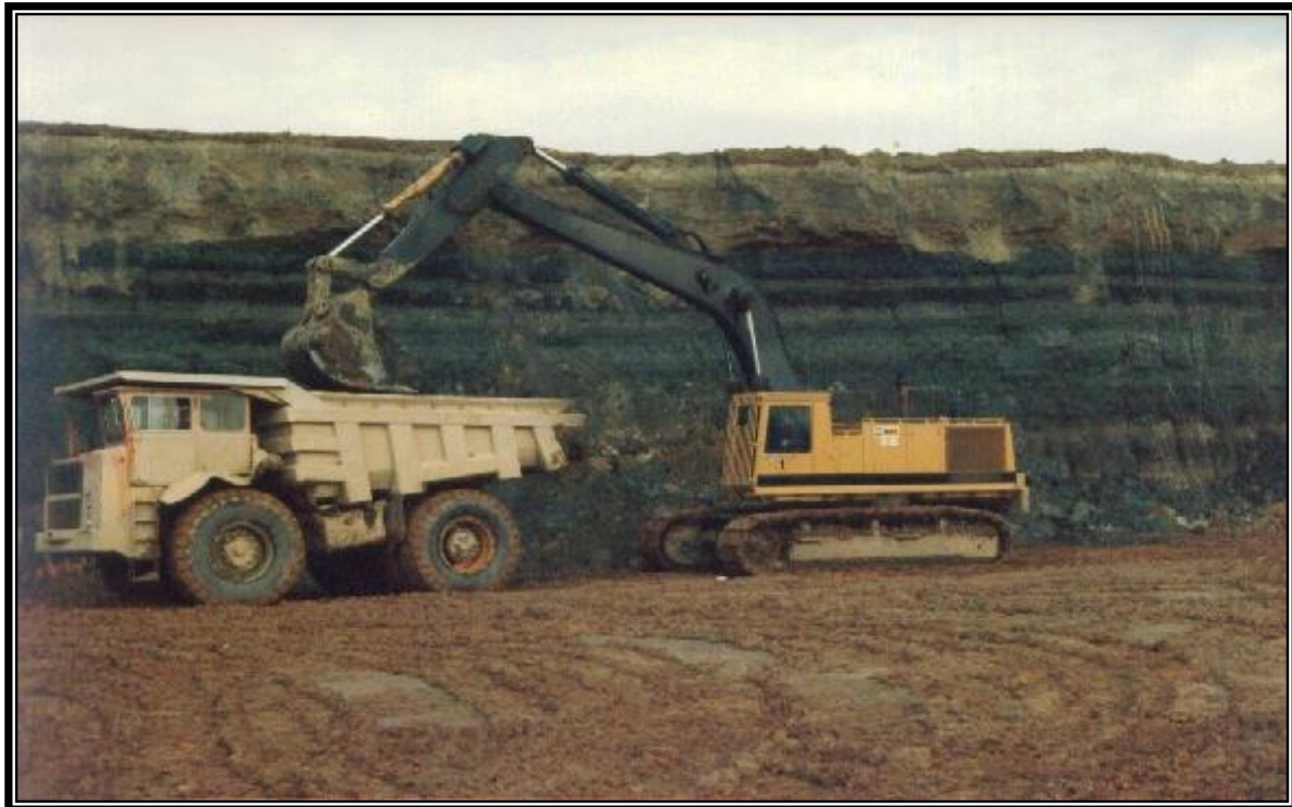
شكل رقم (6-50) احد المقالع يظهر طريقة العمل مع سمك الغطاء صخري بسيط
