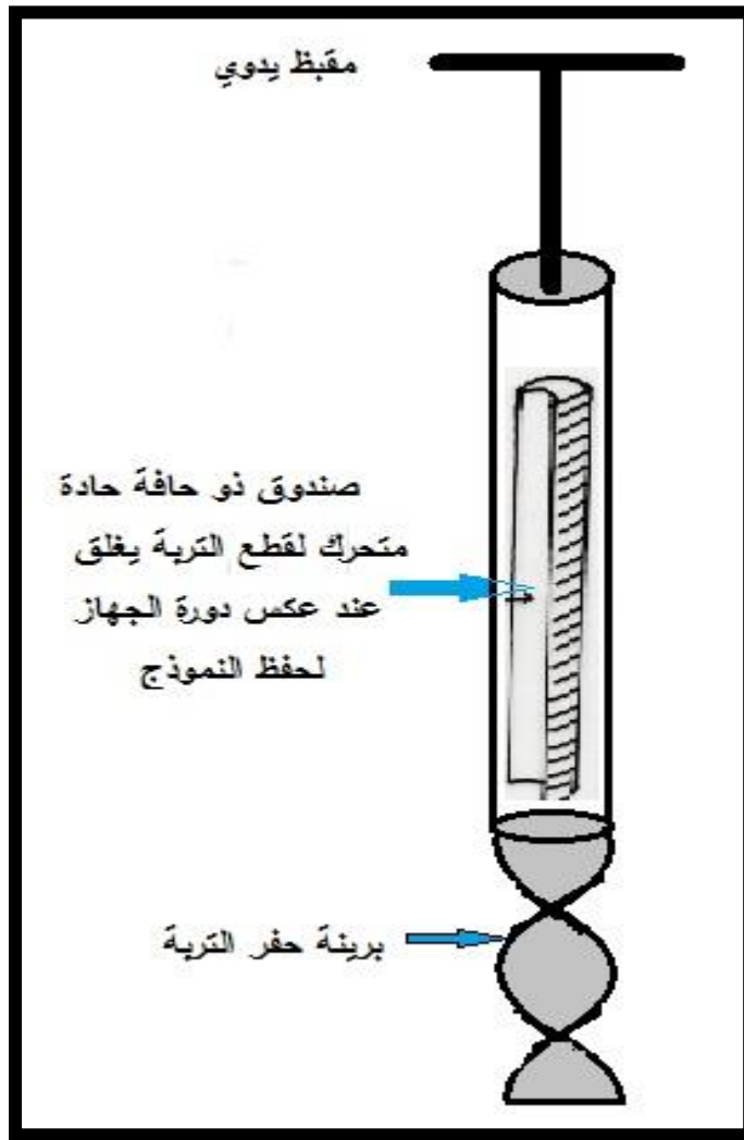
شكل رقم (20-3) مخطط يوضح شكل جهاز حفر التربة (Auger) حديث التصميم
