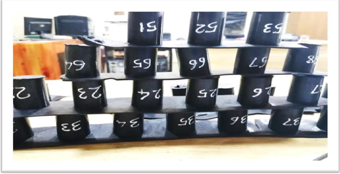
شكل ( ١٠ ) الاسطوانات المطاطية لواشر رأس قنينة الغاز
