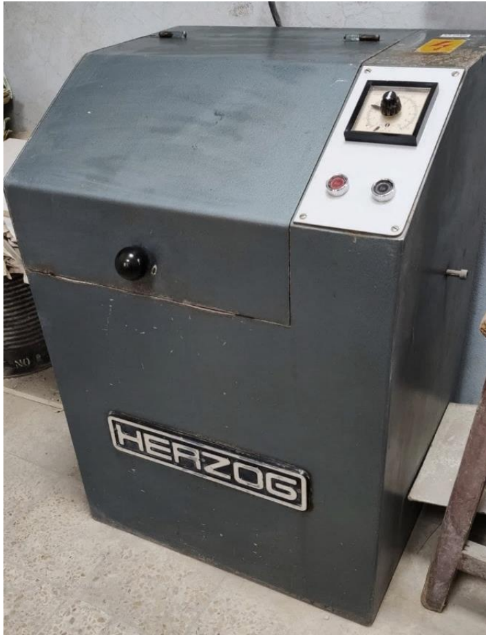
الصورة (2-3): جهاز الطحن (HERZOG) في الورشة الفنية التابعة لقسم علوم الأرض، جامعة الموصل
