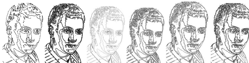
Рис. 2.19. Примеры выделения контуров из изображения 6 оттенков серого с помощью алгоритмов жука, Собела, Робертса, Лапласа, Кирша, статистического, модифицированного Андреева-Бобкова
