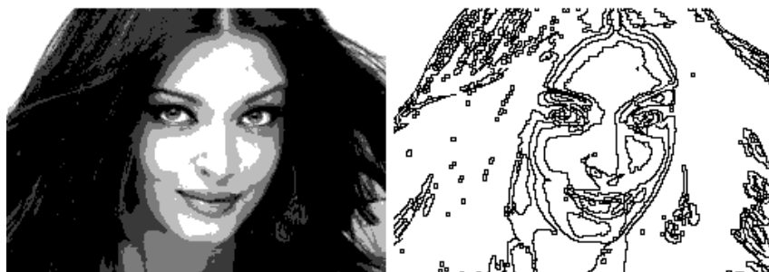
Рисунок 2.11 - Выделение контуров на изображении с 5 оттенками серого цвета
