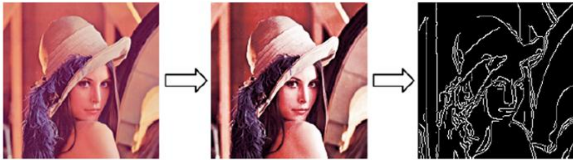
Рисунок 2.5 - Иллюстрация работы контурного детектора Кэнни
