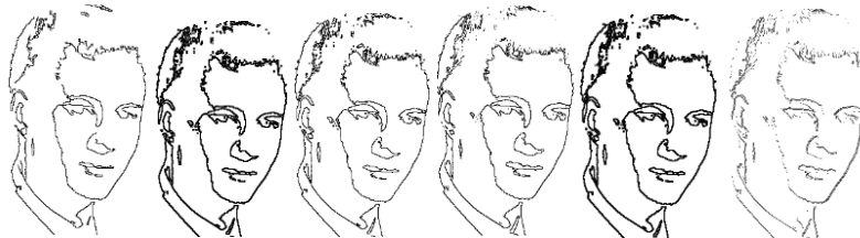
Рисунок 2.18 - Примеры выделения контуров из черно-белого изображения с помощью алгоритмов жука, Собела, Робертса, Лапласа, Кирша, статистического, модифицированного Андреева-Бобкова
