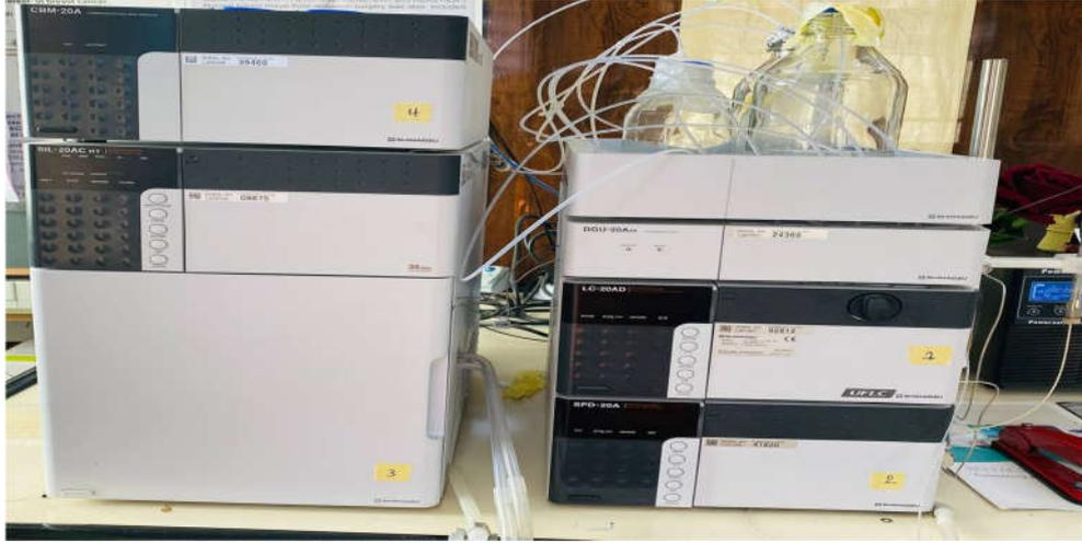
شكل (٤) جهاز الاستشراب السائل HPLC
