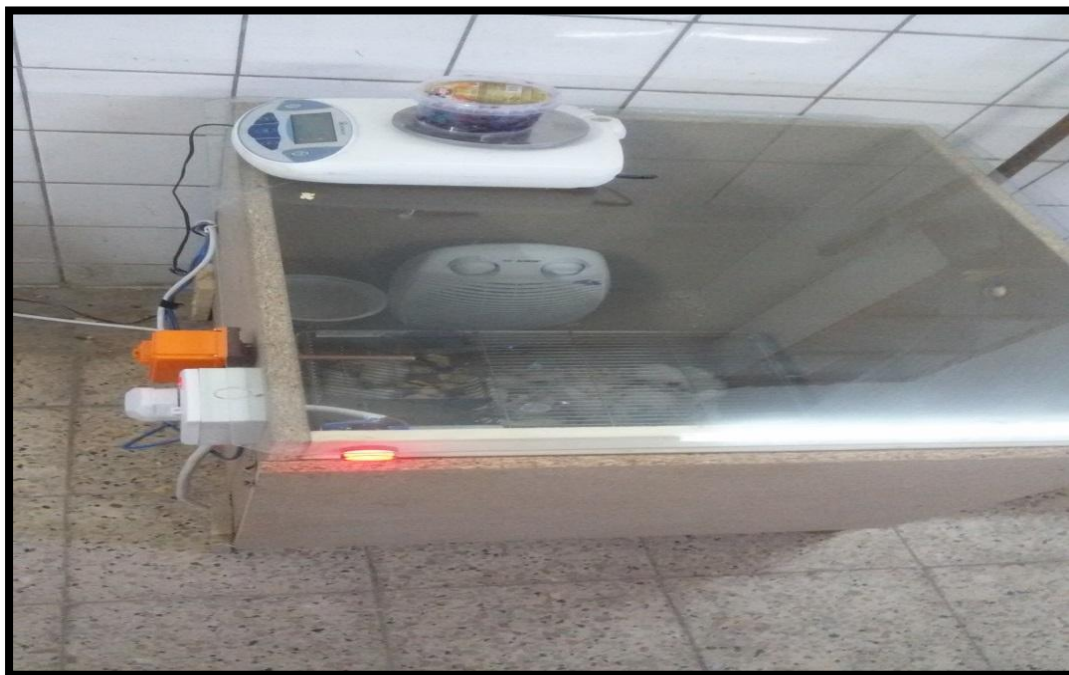
الشكل (4) يمثل حاضنة خشبية محلية الصنع لاستحداث الإجهاد الحراري
