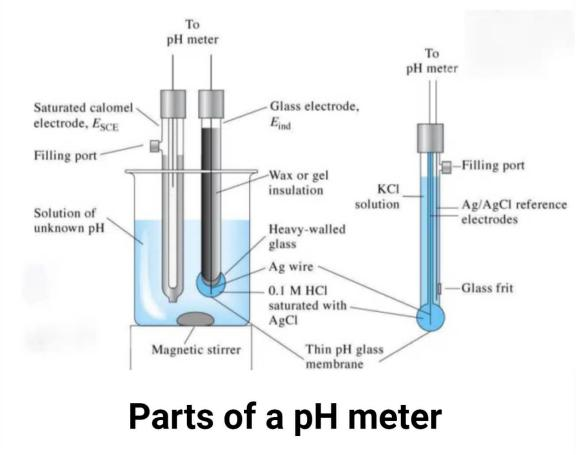
الشكل: أجزاء جهاز قياس الرقم الهيدروجيني.
