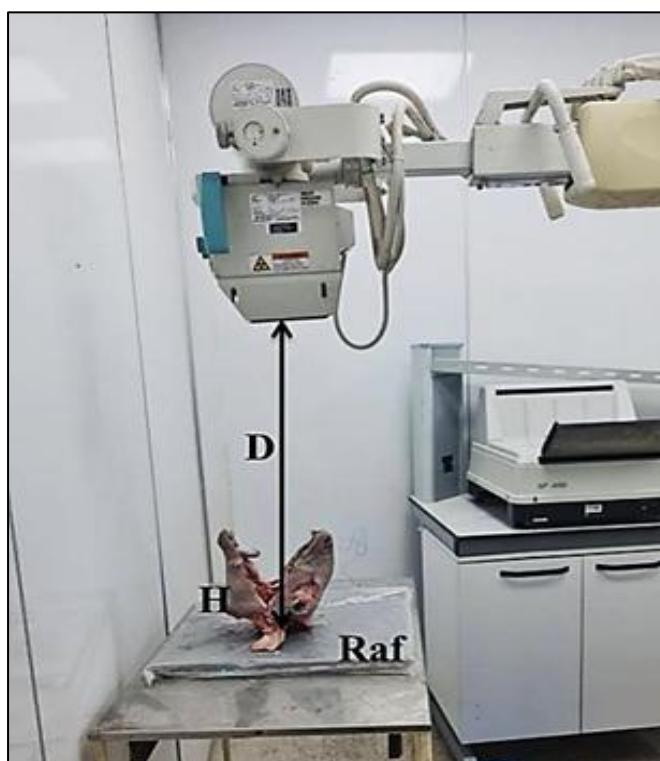
الشكل (3-2): يوضح جهاز الاشعة السينية، رأس الحيوان: H، وضع فوق الفلم الشعاعي: Raf، وعلى مسافة 90 سنتمتر من فوهة الجهاز: D.
